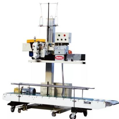
Автоматическая зашивочная машина серии FBS-20 предназначена для складывания верха и зашивки ПП, ПЕ плетеных пакетов, широко применяется в пищевой, химической и др. промышленности. Машина применяет фотоэлектрический контроль, отвечающий за процессы складывания верха пакета, зашивки, обрезки нити и т.д.
