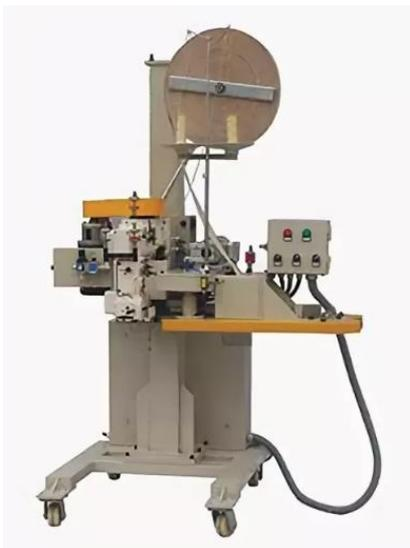
Автоматическая зашивочная машина серии FBS-10 предназначена для складывания верха и зашивки плотных бумажных пакетов, широко применяется в пищевой, химической и др. промышленности. Машина применяет фотоэлектрический контроль, отвечающий за все процессы (обрезка пакета, обвязка бумажной лентой, зашивка, обрезка ленты и нити).
