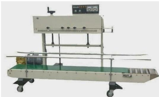
Конвейерный роликовый запайщик для тяжелых пакетов серии FR-1120AL специально разработан для запайки тяжелых пакетов из плотного материала, модель FR-1120AL/ST может быть использована в производственной линии.
