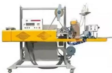
Однолинейная запаивающая и зашивочная автоматическая машина серии FBK применяется для упаковки однослойных крафт-мешков, многослойных крафт-мешков, бумажно-пластиковых ламинированных пакетов и т.д. Может автоматически совершать процессы обеспыливания, зашивки, обрезки нити, подгибки края, обрезки, запайки, подсчета и т.д., что обеспечивает прекрасное качество упаковки, защиту от пыли, насекомых, грязи и т.д.
