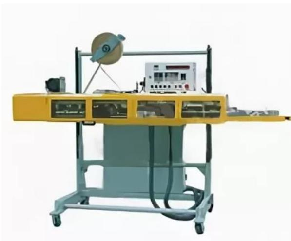
Автоматическая однолинейная прошивочная упаковочная машина серии FBF— предназначен для упаковывания в бумажные пакеты, а также в многослойную бумагу. Машина автоматически упаковывает проставляет дату, оснащена счетным устройством.
