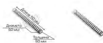
**Пружина защитной крышки
