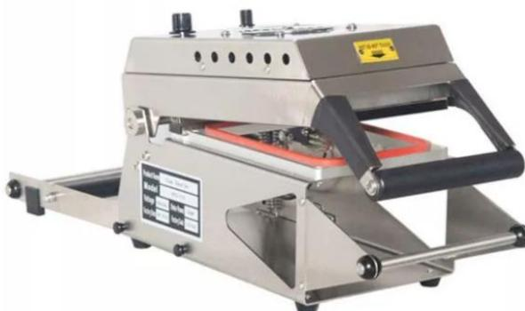
Ручной запайщик лотков HTS-225 выполнен полностью из нержавеющей стали, имеет компактные размеры и низкую потребляемую мощность. Отлично подходит для небольших производств, супермаркетов, столовых и т.д. Оснащен механизмом, позволяющим регулировать температуру запайки и реле времени для установки времени запайки. Подача пленки осуществляется вручную. Автоматическая обрезка пленки. Матрица съемная.
