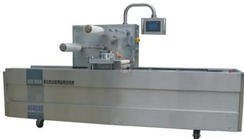
Оборудование серии DZQ-210H предназначается для запайки лотков с разнообразной продукцией. В процессе упаковки осуществляется вакуумизация, выполняется процедура заполнения остатков воздуха инертным газом, остатки пленки обрезаются по контуру контейнера.
