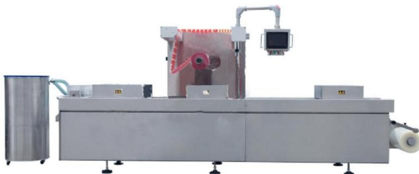
Автоматическая термоформовочная машина HVR-420A автоматически совершает такие операции как формование из пленки лотков (формирование упаковки происходит из нижней и верхней пленок), вакуумирование и газонаполнение, запайка, печать информации на упаковке (опция), разрезании упаковок, формирование язычка для легкого открытия и т.д. Подача продукта может осуществляться как вручную, так и автоматически. Применяется для упаковки самой разнообразной продукции.
