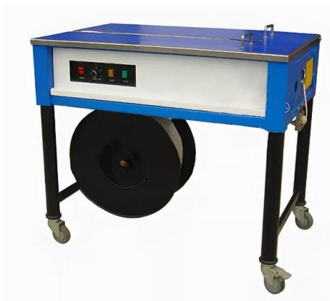
Полуавтоматические стрейпинг машины серии KZB применяются для обвязки полипропиленовой лентой различных объектов: коробок, ящиков, контейнеров, книг, мягких и твердых предметов различной формы. Модель KZB-I и модель KZB-A (высокий стол) предназначены для средних по размерам и весу объектов, в то время как модели KZB-II и KZBD-A применяются для тяжелых и габаритных объектов. Из полуавтоматов наиболее популярны напольные модели KZB-I (с закрытым столом) и KZB-A (с открытым столом).
