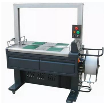
Автоматические стрейпинг-машины высокого типа серии KZ предназначены для средних по размерам и весу объектов. Верхняя часть стола у машин KZ-G оснащена роликами для обеспечения обвязки с применением меньшей силы. KZW машины могут использоваться в производственной линии, где объекты различаются между собой размером и формой, верхняя часть стола имеет ленточный конвейер, адаптирован трансмиссионный механизм.
