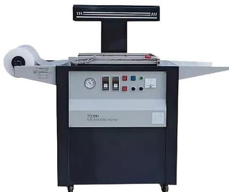
Скин-упаковочные машины серии ТВ отличаются легкостью эксплуатации и широким диапазоном применения, так как могут упаковать практически любой предмет, при этом упаковка отличается прочностью, влагостойкостью, защищает от грязи и пыли и имеет привлекательный внешний вид. Используется специальная пленка для скин упаковки
