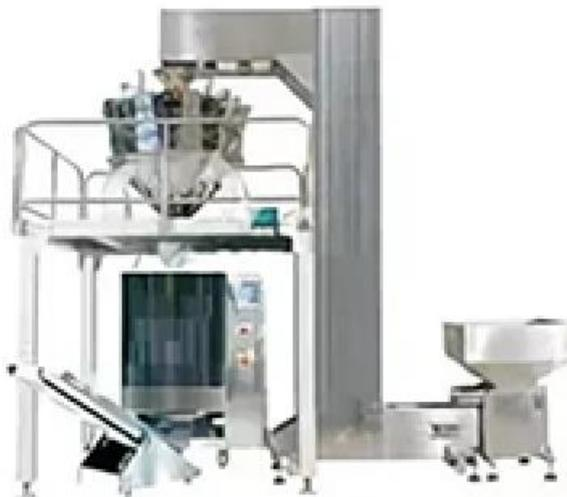
Данная линия автоматически совершает процесс загрузки материала, весового дозирования, наполнения и изготовления пакета, проставления даты, отвода готовой продукции.
