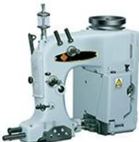
Мешкозашивочная голова GK-35-2C предназначена для зашивания плотных бумажных, полипропиленовых, полиэтиленовых, тканых мешков. Часто встраивается в стационарные установки и упаковочные линии. Применяет полуавтоматический смазочный механизм, механическая обрезка нитки, регулируемый прижим. Стежок двухниточный.
