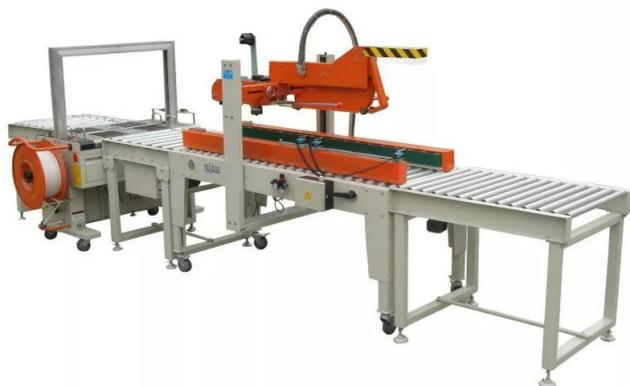
Автоматическая упаковочная линия для заклейки и обвязки коробов XFK-2 позволяет осуществлять автоматическое складывание ушей, заклейку и высокоскоростную обвязку. XFK-2 используется для непрерывной заклейки и обвязки коробов одинакового размера, либо нескольких типоразмеров
