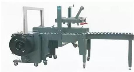
Автоматическая упаковочная линия для заклейки и обвязки коробов XFK-1 состоит из автоматического заклещика коробов, автоматической стрейпинг-машины и отводящего конвейера. Составляющие линии могут работать как вместе, так и независимо друг от друга.
