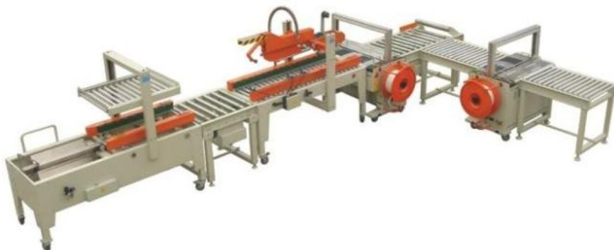
Автоматическая линия для заклейки и обвязки коробки серии XFK-3 может автоматически совершать операции подгибки нижних ушей и заклейки дна коробки, заклейки верха коробки, поворота упаковки на 90°, обвязки крест накрест (форма типа «#»).
