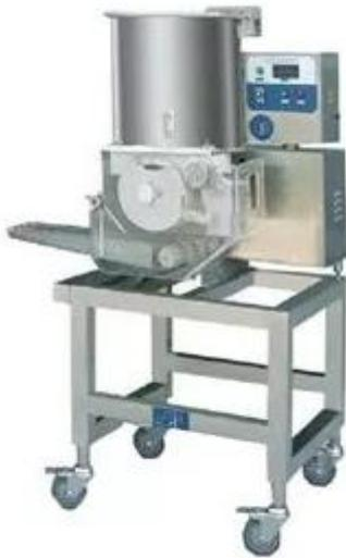
Аппарат можно укомплектовать большим количеством сменных барабанов для изготовления изделий любой формы – от классической круглой до фигурной. По заказу клиента возможно изготовление барабана для формования изделий с индивидуальным дизайном.
