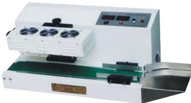
Настольные конвейерные индукционные запайщики серии LGYF-1500A-I применяются для приварки металлизированного комбинированного материала к горловине неметаллических емкостей (пластиковых, стеклянных и т.д.) с диаметром  $\varnothing 20-50$  мм. Оборудование в основном рассчитано на среднюю и большую производительность.
