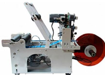
Полуавтоматический этикетировщик (аппликатор) МТ-50 с датером – универсальное устройство для наклейки на цилиндрическую тару самоклеющихся этикеток и одновременного проставления на ней даты. Аппарат является бюджетным аналогом популярной модели этикетировщика НЛ-50. При меньшей цене он сохранил основной функционал своего более дорогостоящего аналога.
