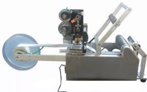
Полуавтоматический этикетировщик (аппликатор) HL-50 с датером предназначен для нанесения самоклеящихся этикеток и проставления даты на банки, бутылки и другие емкости, имеющие округлую и цилиндрическую форму. Оптимально подходят для небольших производств пищевой, косметической и химической промышленности.
