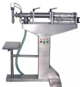
Дозатор LPF-100 предназначен для розлива таких жидкостей как: вода, молоко, соки, технические жидкости и другие продукты с хорошей текучестью. Дозатор может работать как в автоматическом режиме, так и от привода ножной педали. Модель LPF-100 работает с малыми дозами от 10 до 100 мл. Аппарат установлен на напольной станине, общая высота 105 см. Для работы с дозаторами серии LPF требуется наличие воздушного компрессора(не входит в комплектацию оборудования). Диаметр выходного отверстия – 7 мм.
