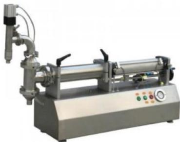
Настольный дозатор LPF-100T применяется для розлива жидких продуктов и продуктов с хорошей текучестью малыми дозами от 10 до 100 мл, диаметр сопла на выходе – 7 мм.
