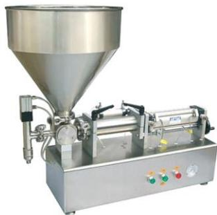
Поршневые дозаторы PPF-100T предназначены для розлива жидких, а также вязких и густых продуктов (распущенный мёд, майонез, кетчуп, соусы, масло, косметические смеси и пр.).
