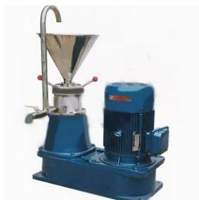
Коллоидная мельница типа JMV предназначена для гомогенизирования, превращения в эмульсию, разделения и смешивания жидкостных и полужидких материалов путем резки, размалывания и тряски благодаря эффекту центробежной силы и соразмерно высокой скорости между постоянным и вращающимся механизмом. Коллоидные мельницы широко применяются в пищевой, химической и медицинской отраслях.
