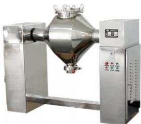
Данная машина разработана с учетом современных технологий, имеет двойной конус миксера, что позволяет производить более качественные смеси. Применительно машина используется в пищевой промышленности, химической промышленности, фармацевтике.
