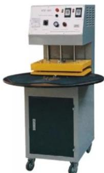
Упаковочные машины XBF широко применяются для сварки блистеров и соответственно упаковки различного рода изделий: электронных компонентов, игрушек, небольших предметов и т.д. Блистерная упаковка отличается прочностью, влагостойкостью, современным и привлекательным внешним видом.
