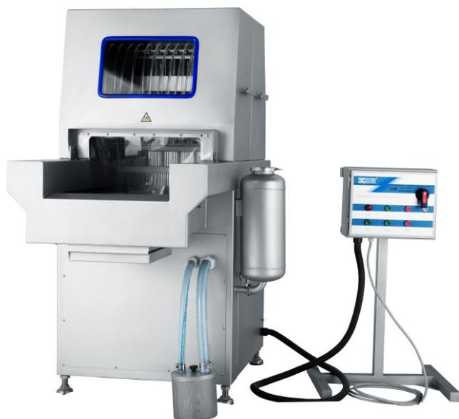
Инъектор ZS88 представляет серию современных инъекторов для посола костного и бескостного кускового сырья – мяса, птицы, рыбы. Данная модель имеет регистр на 88 игл, диаметр игл (по выбору заказчика) – 2, 3 и 4 мм. По умолчанию ставится комплект игл на 4 мм. Станция для приготовления рассола в комплекте не поставляется. Функциональные возможности аппарата позволяют удовлетворить запросы самых взыскательных заказчиков со сложными технологическими процессами.
