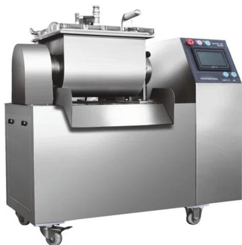
Чтобы добиться получения продукции высокого качества, необходимо использовать на производстве надежное и высокотехнологичное оборудование. Вакуумная лопастная тестомесильная машина ZKHM-75 предназначена для приготовления теста на любом пищевом производстве средней мощности. Эргономичный дизайн аппарата сочетается с надежностью и качеством, сравнимыми с европейским уровнем.
