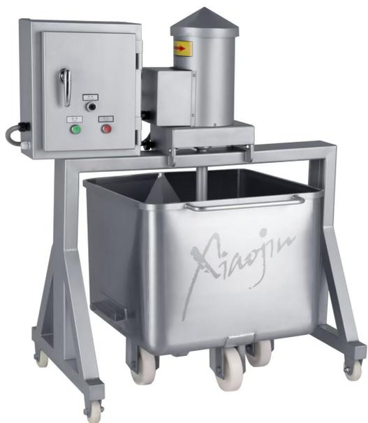
Оборудование предназначено для изготовления рассолов, путем перемешивания воды, соли, специй и добавок. Использование станции подготовки рассола YSZ-200 имеет множество преимуществ, включая повышение эффективности производственных процессов, улучшение качества продукции, снижение рисков возникновения проблем и оптимизацию расходов на сырье.
