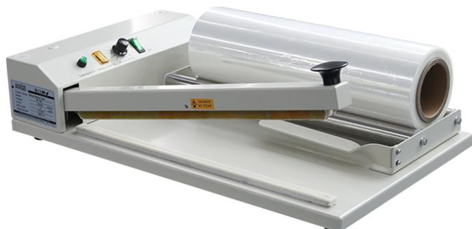
Модель SP 450 представляет серию ручных импульсных запайщиков с запаечным элементом типа «струна». Он одновременно выполняет функции запайки и обрезки. Толщина струны 0,5 мм. Максимальный размер пакета 450х450 мм. Импульсная технология запайки обеспечивает экономичное энергопотребление.
