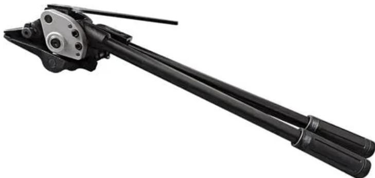
Ручной натяжитель SKL32B от компании Hualian представляет собой сверхмощный механический обвязочный инструмент для обвязки объектов стальной лентой шириной 19, 25 или 32 мм. Ширина используемой ленты указывается покупателем при оформлении заказа. Рекомендуемая толщина стальной ленты – от 0,8 до 1,2 мм.
