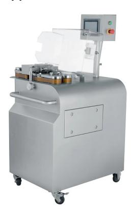
Делитель сосисочных гирлянд RJJ01 предназначен для автоматического разделения гирлянд сосисок. Особенностью оборудования является регулируемая скорость до 60 м. в минуту и адаптация к широкому размерному ряду сосисок, шпикачек и сарделек. Устройство работает одинаково эффективно как с натуральными, так и искусственными оболочками.
