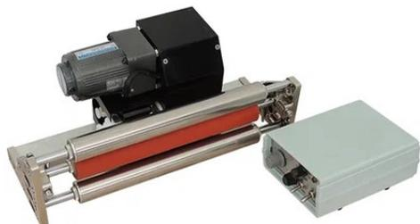
Датеры МУ-812А применяются для нанесения даты и встраиваются в фасовочные машины. Модель датера МУ-812А подходит для подключения к оборудованию, работающему в непрерывном режиме (горизонтальные фасовочно-упаковочные машины). Датер наносит печать при помощи красящего ролика. Поставляется со станиной, на выбор заказчика предлагаются станины размером 400, 500 и 600 мм. Датер МУ-812А работает от собственного двигателя.
