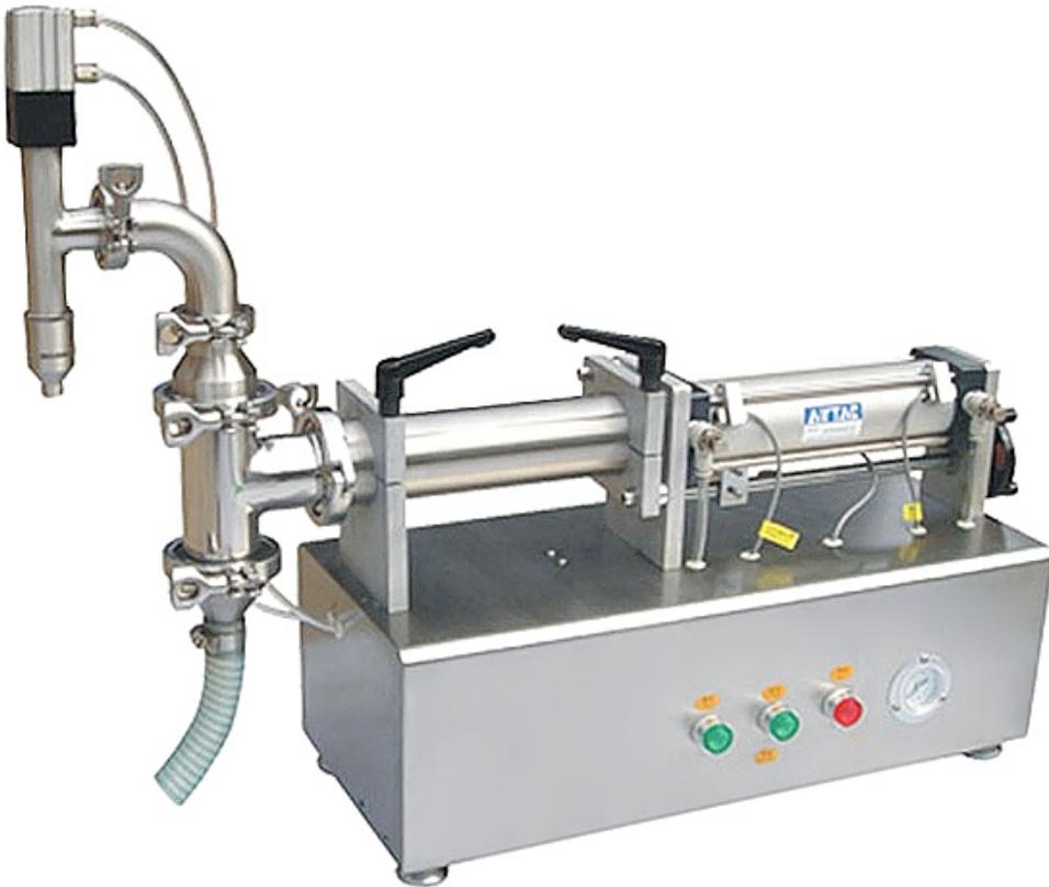
Дозаторы серии LPF применяется для розлива жидких продуктов и продуктов с хорошей текучестью без включений. Дозатор серии LPF закачивает продукт из ёмкости и подаёт с помощью шланга в любую тару в требуемом объёме, дозировка у модели LPF-500T варьируется в диапазоне от 100 до 500 мл. Дозатор может работать как в автоматическом режиме, так и от приводной педали. Для работы с дозатором серии LPF требуется наличие воздушного компрессора (не входит в комплектацию оборудования).
