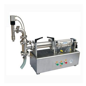
Настольный дозатор LPF-100T применяется для розлива жидких продуктов и продуктов с хорошей текучестью без включений малыми дозами от 20 до 100 мл, диаметр сопла на выходе – 7 мм.
