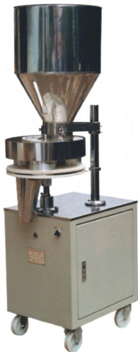
Объемно-ротационный дозатор предназначен дозирования не пылящих порошков и гранулированных продуктов, специи, соль, сахар, бакалея, бытовая химия и т.д. Дозирование происходит за счет стаканов с изменяющимся объемом.
