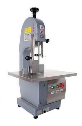
Пила ленточная JG-210 предназначена для разделывания и нарезки замороженных либо подмороженных продуктов, в том числе мясокостного сырья; для свежего и охлажденного продукта ленточные пилы, как правило, не подходят. Нарезка происходит за счет высокой скорости вращения пильного полотна (пильное полотно представляет собой гибкую непрерывную ленту с многочисленными зубьями по краю). Толщина нарезки регулируется от 5 до 155 мм, также регулируется и натяжение полотна.
