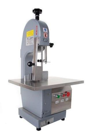
Пила ленточная JG-210 NEW предназначена для разделывания и нарезки замороженных либо подмороженных продуктов, в том числе мясокостного сырья; для свежего и охлажденного продукта ленточные пилы, как правило, не подходят. Нарезка происходит за счет высокой скорости вращения пильного полотна (пильное полотно представляет собой гибкую непрерывную ленту с многочисленными зубьями по краю). Толщина нарезки регулируется от 5 до 155 мм, также регулируется и натяжение полотна.
