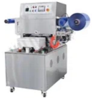
Преимуществом данной модели является увеличенная производительность за счет большего количества одновременно упаковываемых лотков. Опционально аппарат можно укомплектовать дополнительными наборами матриц под различные типоразмеры лотков и вакуумным насосом увеличенной мощности, а также насосом известного немецкого бренда BUSCH. В базовой же комплектации установлен вакуумный насос мощностью 63 м<sup>3</sup>/час.
