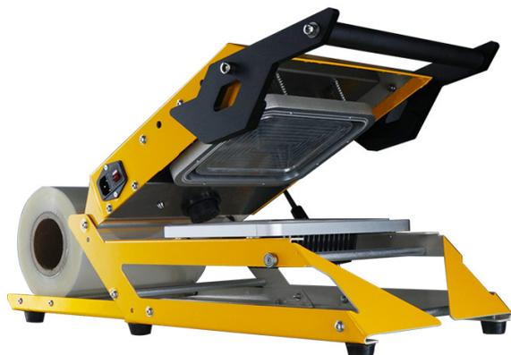
Ручной запайщик лотков HTS-210R (трейсилер) предназначен для запайки лотков с продовольственной и непродовольственной продукцией при помощи оператора. Готовый контейнер получается надежным и герметичным. Несмотря на ручной тип управления, устройство сокращает количество действий вручную. Например, благодаря механизму обрезки не нужно обрезать пленку вручную. Это происходит автоматически вместе с запайкой.
