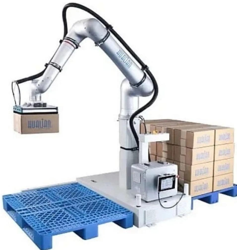
Робот-паллетайзер HRP-25/5B – это модель оборудования, которое в автоматическом режиме выкладывает грузы на паллет. Используется на складах, в логистических центрах и пр. Аппарат может укладывать на поддомен мешки, ящики, коробки. Работа паллетоупаковщика – это последний этап в сборочной линии, далее уже собранные поддоны отправляются на транспортировку.
