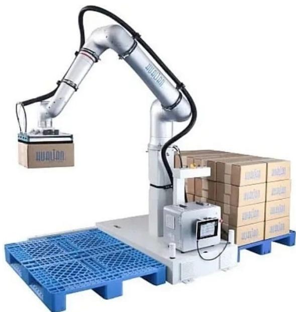
Робот-паллетайзер HRP-25/5A – это модель оборудования, которое в автоматическом режиме выкладывает грузы на паллет. Используется на складах, в логистических центрах и пр. Аппарат может укладывать на поддомен мешки, ящики, коробки. Работа паллетоупаковщика – это последний этап в сборочной линии, далее уже собранные поддоны отправляются на транспортировку.
