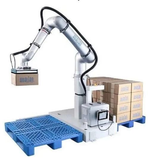
Робот-паллетайзер HRP-20/6A – это модель оборудования, которое в автоматическом режиме выкладывает грузы на паллет. Используется на складах, в логистических центрах и пр. Аппарат может укладывать на поддомен мешки, ящики, коробки. Работа паллетоупаковщика – это последний этап в сборочной линии, далее уже собранные поддоны отправляются на транспортировку.
