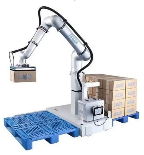
Робот-паллетайзер HRP-20/6В – это модель оборудования, которое в автоматическом режиме выкладывает грузы на паллет. Используется на складах, в логистических центрах и пр. Аппарат может укладывать на поддомен мешки, ящики, коробки. Работа паллетоупаковщика – это последний этап в сборочной линии, далее уже собранные поддоны отправляются на транспортировку.
