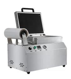
HLV-300VST — увеличенная модель ручного вакуумного пищевого скин-упаковщика на базе модели HLV-240VST. Максимальные габариты лотка (ШхВ) в данной модели составляют 175х260 мм в двухлотковом варианте матрицы и 350х260 мм — в матрице с одним лотком. Максимальная глубина лотка в данной модели — 40 мм. В продаже также имеются конфигурации с увеличенной глубиной — 55 мм. Матрицы могут изготавливаться по индивидуальным параметрам заказчика по запросу.
