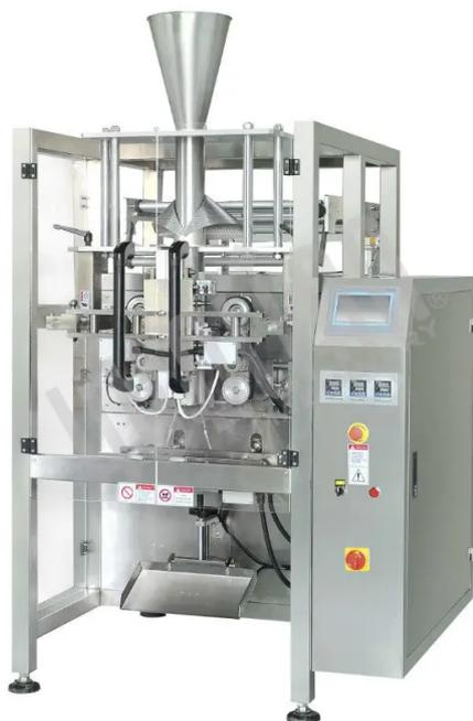
Автоматическая упаковочная машина HLNV-520 с большим комбинированным мультиголовочным дозатором предназначена для дозирования и упаковки различных сыпучих, мелкофракционных и гранулированных продуктов, как, например: воздушный рис, семечки, орехи, бобовые, кофе в зернах, гранулированные корма для животных, печенье, картофельные чипсы, крекеры и т.п.
