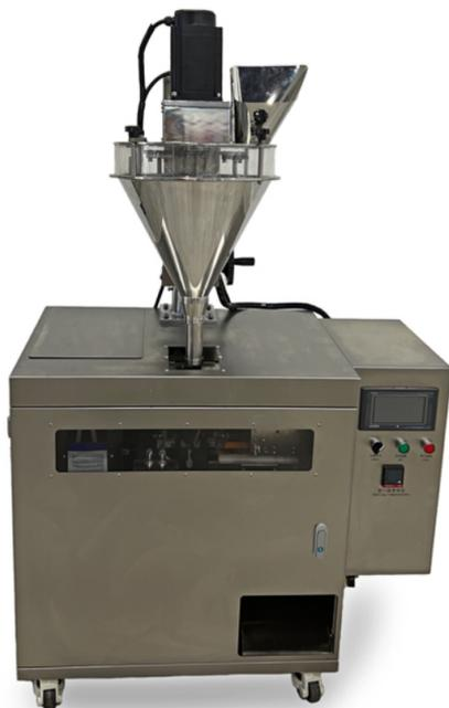
Мини дой-пак линия со шнековым дозатором HLDX-9018F предназначена для фасовки порошкообразных продуктов в готовые пакеты дой-пак. Шнековый дозатор отмеряет заданную дозу по объему. Погрешность составляет не более 2 г.
