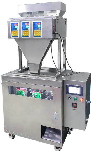
HLDX-500 – еще одна модель в серии мини дой-пак линий HLDX для упаковки сыпучей продукции в готовые пакеты типа «дой-пак» с замком зип-лок. Диапазон дозирования в данной модели – до 500 г. Для фасовки используется весовой тип дозирования – модель оснащена высокоточным весовым дозатором. Отклонение от заданного веса дозы составляет не более 2 грамм и зависит от плотности фасуемого продукта.
