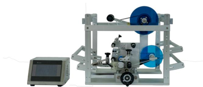
Этикетировочные машины используются для нанесения этикеток на поверхность товара. Оборудование актуально на производственных цехах и предприятиях. Одним из таких устройств является этикетировочная машина HL-816. Устройство с высокой точностью наклеивает этикетки, и может быть применено как для горизонтальных, так и вертикальных упаковочных машин, работая в режиме конвейера.
