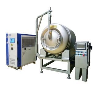
Модель мясомассажера GRKL-1000 бережно обрабатывает сырье без нарушения целостности продукта с сохранением внешнего вида. Использование устройства позволяет сократить пористость продукции, увеличив и ускорив выход готовых изделий.
