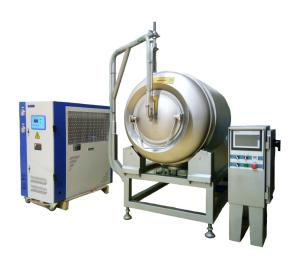
Вакуумный массажёр с охлаждением GRKL-3500 представляет собой оборудование для ускорения процесса посола изделий из мяса и рыбы. Важной особенностью является то, что в процессе массирования создается вакуум, благодаря которому улучшаются вкусовые свойства продукта — мясо становится нежным и вкусным.
