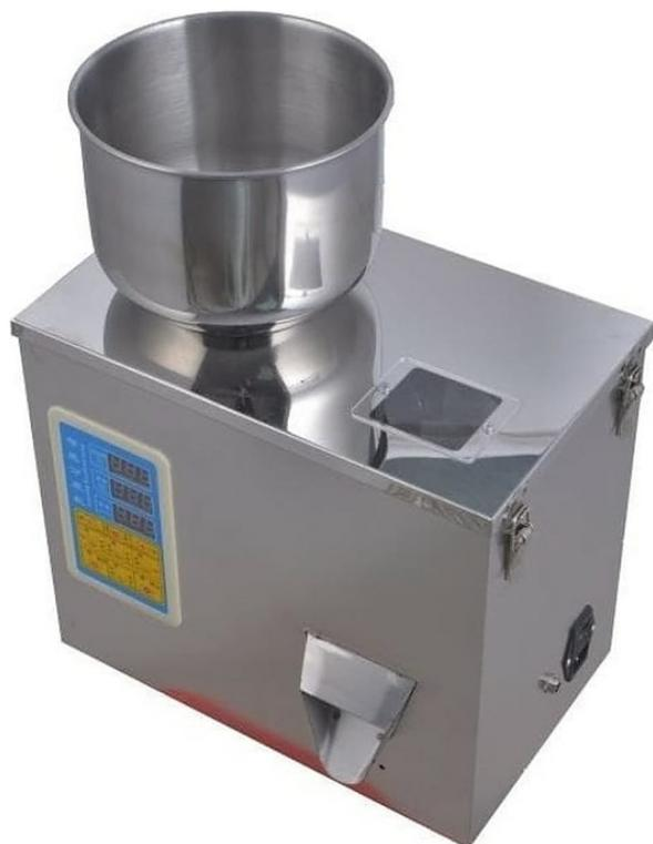
Весовой настольный бункерный дозатор FZ-500 предназначен для фасовки различных легкосыпучих продуктов порошкообразной и гранулированной формы: чая, кофе, специй, сахарной пудры, какао и т.д. Диапазон дозирования от 5 до 500 г. Конкретную величину дозирования оператор выставляет при помощи электронной панели управления. Точность наполнения – 0,2 г.
