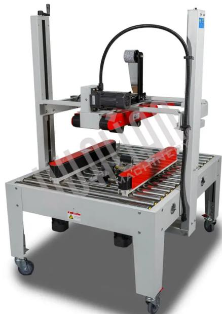
Заклейщик FXJ-8070В является самой габаритной моделью в линейке полуавтоматических заклещиков коробов FXJ. Он предназначен для упаковки коробов габаритами до 700x800 мм, минимальный размер короба 130x130 мм. Подстройка под конкретные размеры выполняется механически, при помощи специальных рычагов.
