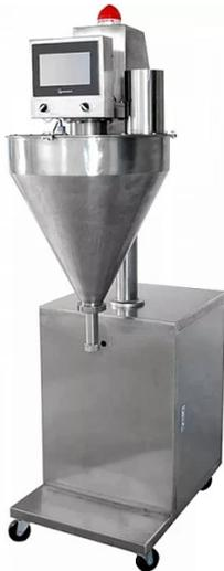
Автоматический дозатор серии FLG применяет шнековый механизм дозирования и PLC-контроллер.
